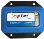
一个低成本的数据记录器, 用于监测冲击, 倾斜, 温度和湿度。通过蓝牙将数据连接到一个免费的 APP 应用程序。
